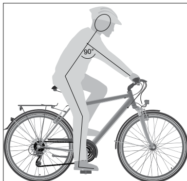
Ill.: Optimal sadelhøjde (eksempel)
